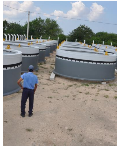
Virolas de los aerogeneradores de LH1.
