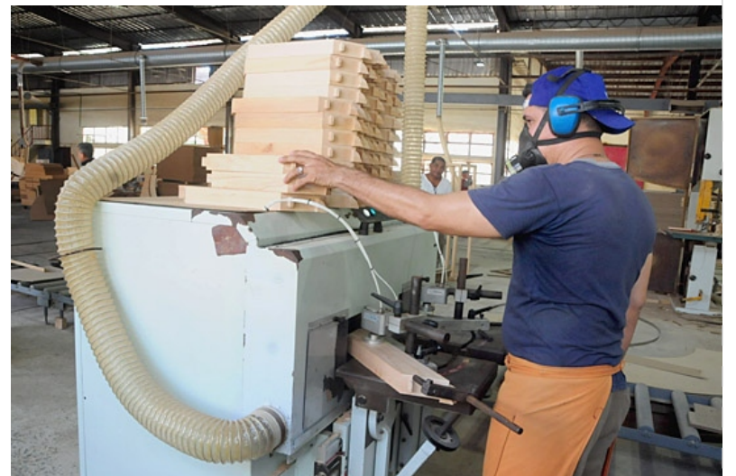
La nueva tecnología está dotada de un sistema centralizado de extracción de impurezas.
